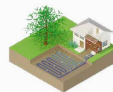
Pompe à chaleur sur capteurs enterrés horizontaux
