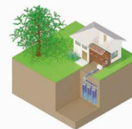
Pompe à chaleur sur corbeilles géothermiques
